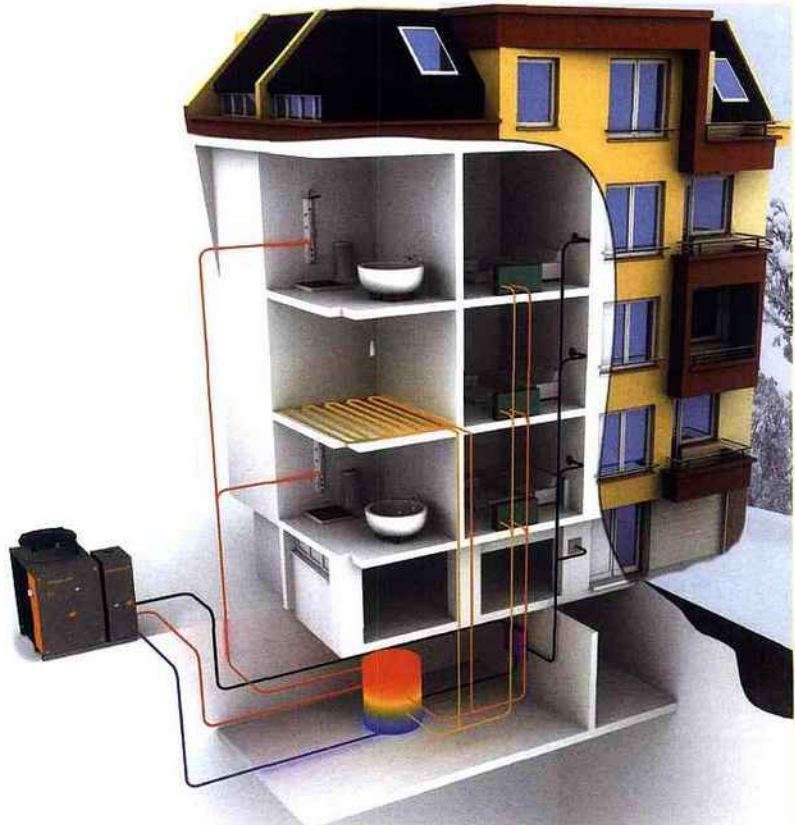
Photo 1 PAC absorption gaz aérothermique sur un immeuble de logements collectif pour la production de chauffage et d'eau chaude sanitaire.
