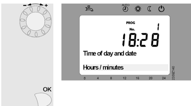
Figure 9 L'écran montre les heures et les minutes à modifier
