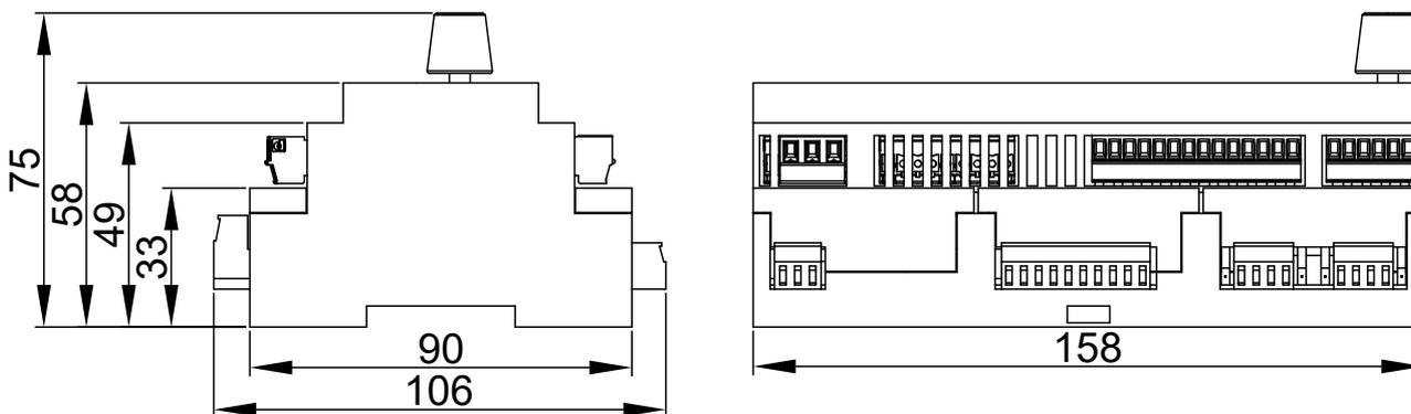
Il dispositivo RB200 ha grado di protezione IP20, e va installato in locali con temperatura aria ambiente compresa tra 0 °C e 50 °C.
