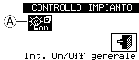
Figura 2.16 Esempio di schermata controllo impianto ACS base o separabile
